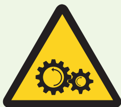
RIESGO DE ATRAPAMIENTO
