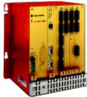
**El PLC de seguridad GuardPLC 2000 es un sistema modular.**
