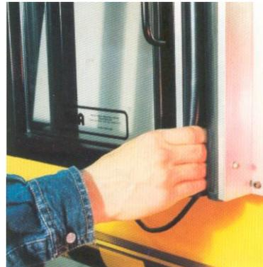
Suelen ser de caucho o neopreno y son de diversas formas dependiendo del fabricante y los distintos modelos; pero en general son como una tubería hueca en cuyo interior se localiza un conductor o conductores sensibles al contacto, de tal forma que cuando se produce una presión en cualquier punto del borde se produce la parada del elemento al que este asociado
