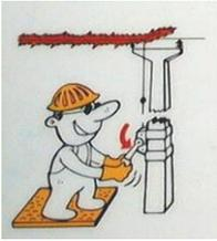
Aísle la parte de la instalación de todas las fuentes de alimentación por una distancia en aire o por la interposición de un aislante suficiente (abrir interruptores, abrir seccionadores, extraer fusibles y/o abrir los puentes, ...).
