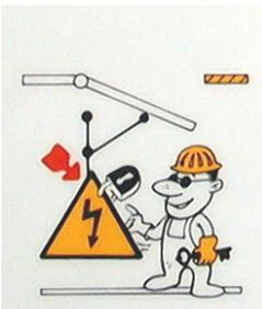
Realice el bloqueo mecánico del mecanismo de maniobra y señalice la prohibición de la maniobra. Si no es posible, se adoptarán medidas de protección equivalentes.
