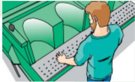
del sistema de accionamiento de la máquina, mando a dos manos, de forma que siempre se tengan que accionar simultáneamente los dos pulsadores para que baje el cabezal. Para poder accionar de nuevo la máquina deberán ser liberados, previamente, ambos pulsadores. Se comprobará que la presión y
