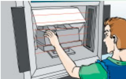
protección, verificando que la barrera fotoeléctrica que impide el acceso involuntario a la zona de acción, el corte del haz, detiene el movimiento peligroso de la máquina.
