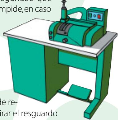
de retirar el resguardo de protección de la cuchilla, el funcionamiento de la máquina. Bajo ningún concepto se anulará o eliminará dicha protección.
