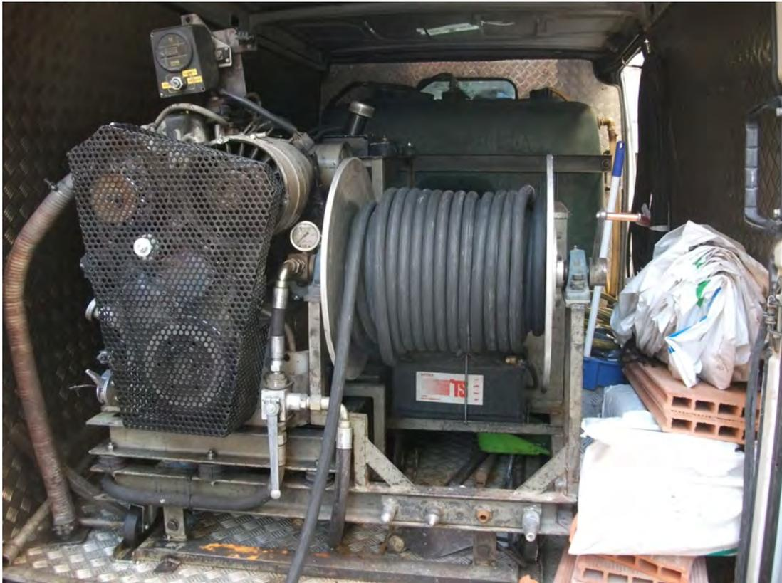
Fig. 14: Equipo de generación diésel en vehículo convenientemente acondicionado.
