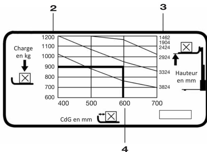
2 Carga máxima de elevación en kg.
