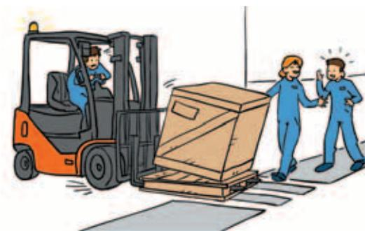
–En el acceso y salida de una carretilla elevadora a un montacargas, confirma si está permitida esa tarea, que la capacidad de carga del mismo es compatible con la máquina y que no hay nadie en su interior, entrando y saliendo siempre en sentido perpendicular respecto a la puerta.
