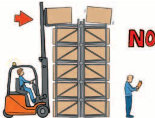
–Nunca deposites cargas cerca de tuberías o instalaciones de servicio para no dañarlas durante la operación.
