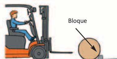
2 Inclina el mástil hacia adelante y desliza las puntas de las horquillas a lo largo del suelo para introducir las por debajo de la carga.
