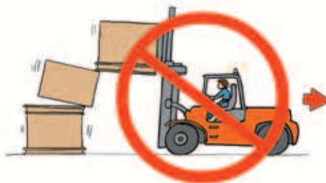
✦ En caso de cargas pesadas, observa previamente que la estantería no será sobrecargada, atendiendo a la placa anexa a la misma y evitando siempre apilar materiales en paletas, encima de otras que puedan comprometer su seguridad.
