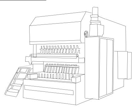
Máquina utilizada para lavar y desinfectar botellas, seleccionar y eliminar las rotas y volver a poner en uso las que se encuentran en buen estado etc.
