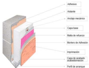
Esquema fachada SATE
