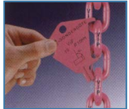
Inspección del alargamiento producido por sobrecarga.
