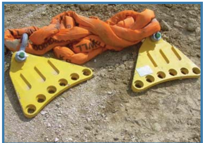
Útil para izar el buje
