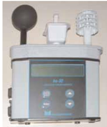
Medidor de estrés térmico índice WBGT.
