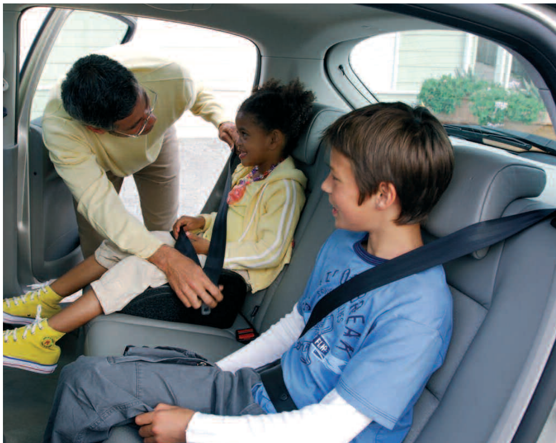
En las plazas traseras el cinturón cumplirá una doble función: evitar las lesiones del ocupante de este asiento y evitar que pudiera llegar a aplastar a quienes viajan en las plazas delanteras.
