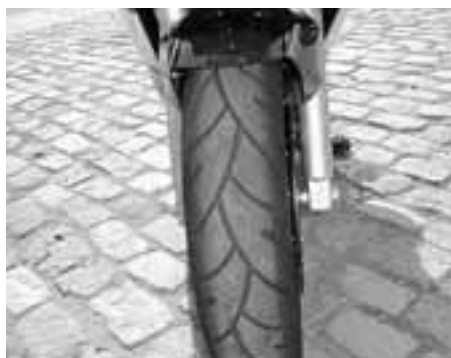
Figura 6.9: Desgaste correcto del neumático de una moto
