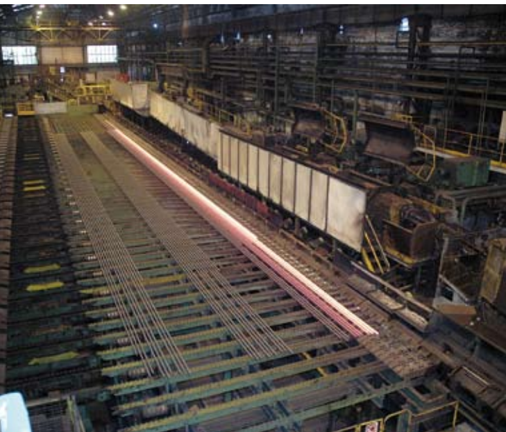
Enfriamiento y corte
