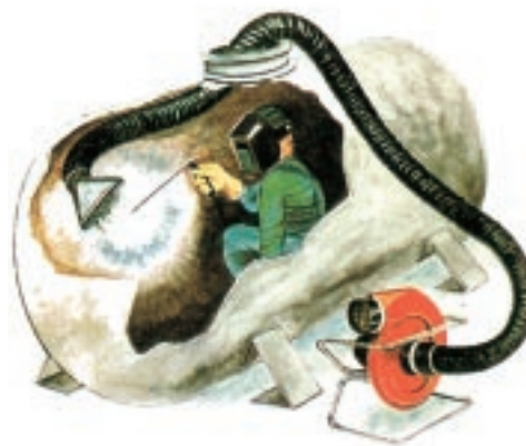
Ventilación por extracción localizada
