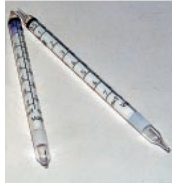
Medición puntual con tubo detector colorimétrico específico para CO 2
