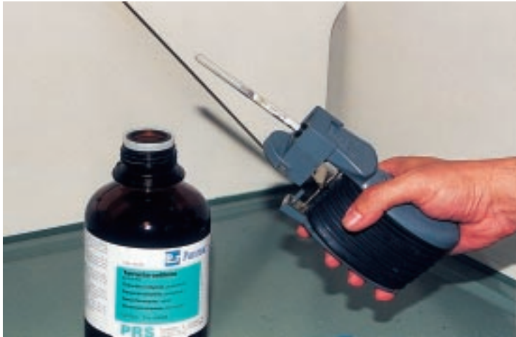
Medición con tubo detector genérico cualitativo (Politest, Qualitest, ...)
