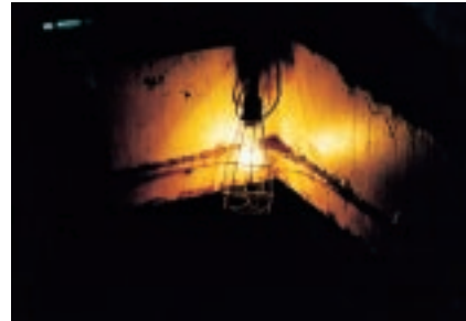
Figura 2: Lámpara portátil convencional sin protección Ex contra ambientes inflamables
