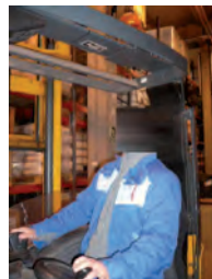
Figura 120 – Instalar un espejo o cámara para evitar la extensión de cuello
