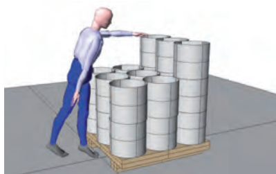
Figura 101 – Plataforma giratoria para facilitar los alcances
