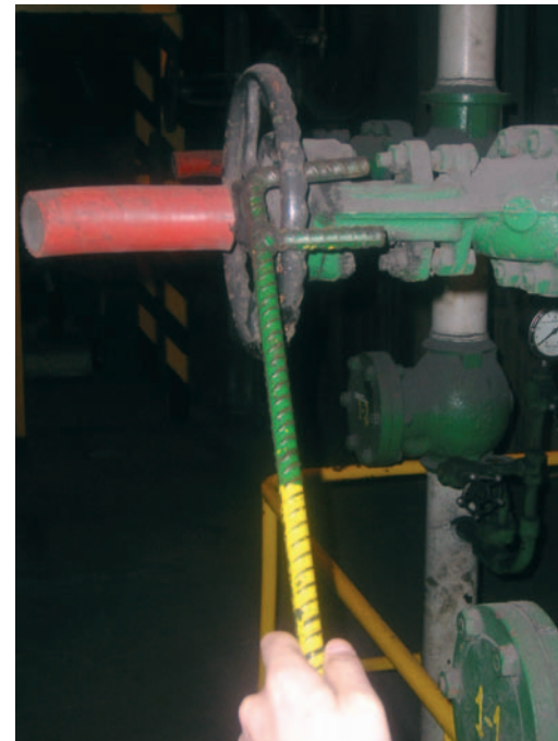
Figura 1.- Útil empleado en la apertura y cierre de válvulas de volante.
