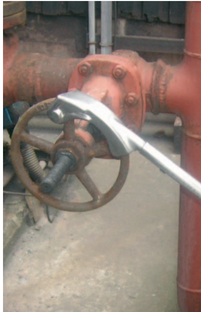
Figura 5.- Llave prototipo en prueba.
