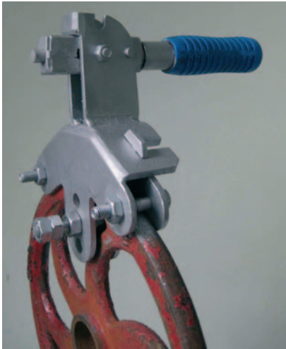
Figuras 7 y 8.- La llave antropométrica fija con el manubrio en posición axial.
