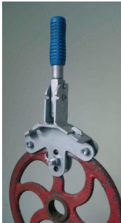
Figuras 9 y 10.- La llave antropométrica fija con el manubrio en posición radial.
