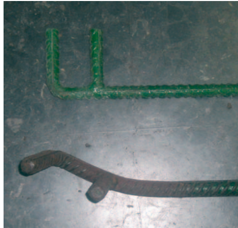
Figura 2.- Útil doblado por efecto de la fatiga.
