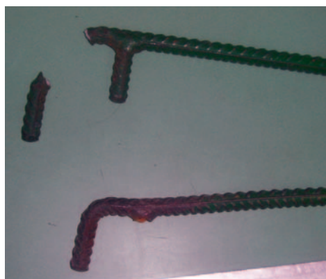
Figura 3.- Útiles rotos por sobreesfuerzos.
