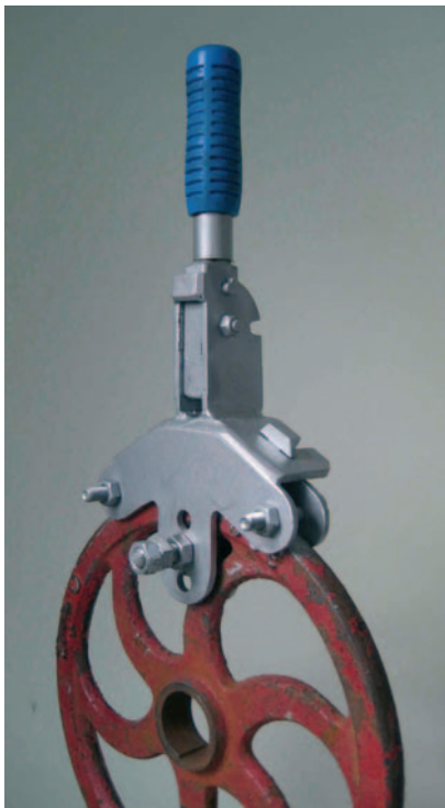
Figuras 9 y 10.- La llave antropométrica fija con el manubrio en posición radial.
