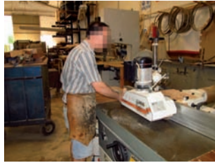
Figura 25. Alimentador para tupí.
