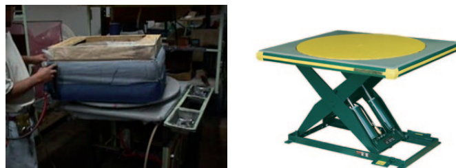
Figura 83. Mesa de trabajo con plataforma giratoria.
