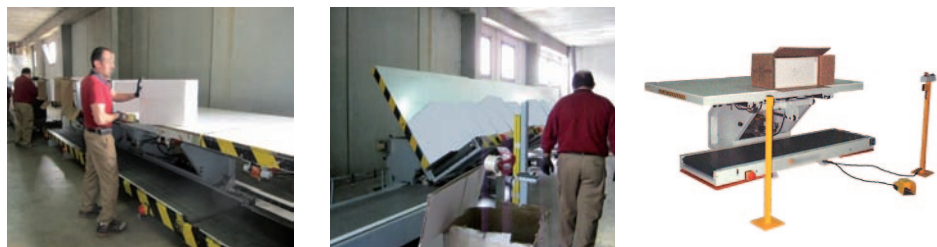
Figura 134. Cinta transportadora con sistema de elevación y volteo.
