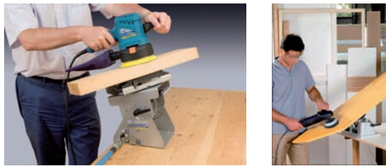
Figura 40. Sistemas de sujeción por vacío para piezas.
