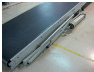
Figura 131. Útil neumático de fabricación propia para el apilado de sofás.
