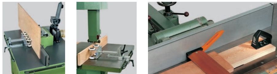
Figura 23. Sistemas de ayuda a la mecanización de piezas en máquinas.
