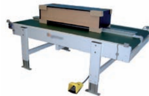
Figura 128. Banco para montaje de cantoneras.
