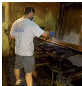
Figura 66. Sistema de transporte con puesto elevable y giratorio.
