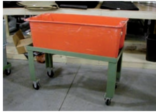
Figura 86. Soporte con ruedas para contenedores.
