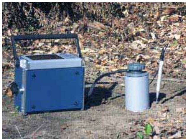
Vista 8. Cámara de medida de respiración del suelo.
