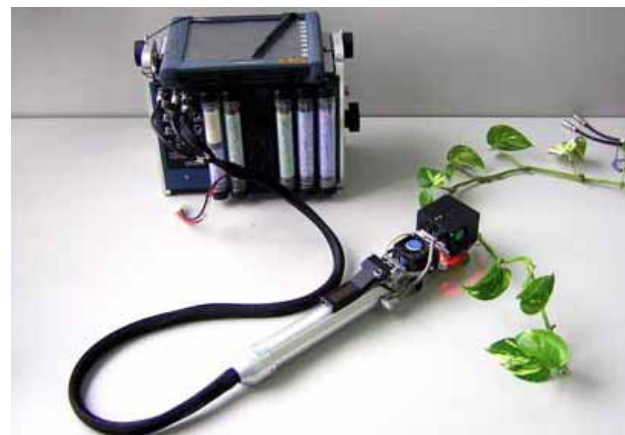
Figura 17. Equipo de intercambio gaseoso.
